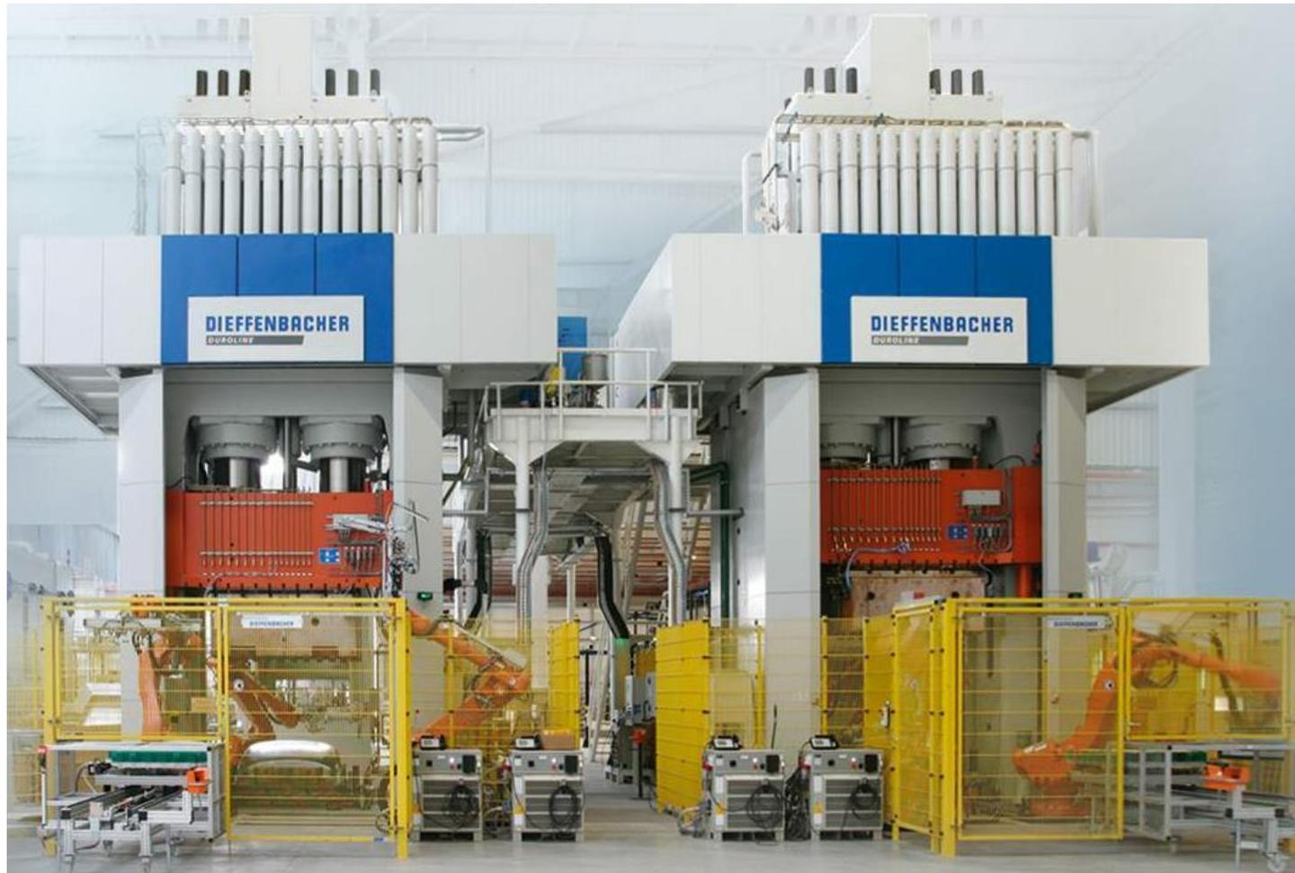
Produktionsstraße zur Herstellung von SMC-Automobilteilen
